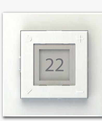
Asetettu lämpötila voi erota halutusta lämpötilasta johtuen eristyksistä, ilmastoinnista, termostaatin paikasta tms. Mikäli aseteltu lämpötila eroaa paljon mitattusta huone- tai lattialämpötilasta voidaan asetettua lämpötilaa kalibroida +/- 5°C.
