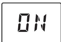
Appuyer simultanément sur les touches et pendant 3 s pour ouvrir le menu de programmation. Sélectionner **ON** avec les touches + et - . Confirmer ensuite avec la touche . **OFF** permet de quitter le menu. **Pr** s'affiche.
