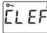
Tasten + und – gleichzeitig 3 s lang drücken, bis **CLEF 1** und das Symbol
