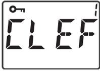
Taste und den Drehregler gleichzeitig 3 s lang drücken, bis **CLEF 1** und das Symbol angezeigt werden. Das Gerät ist gegen unerwünschten Zugriff auf die Einstellungen geschützt, nur der Ein-/Ausmacher kann betätigt und das Gebläse aktiviert werden.
