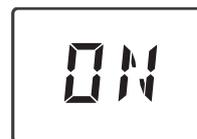
Tasten und **Auto** gleichzeitig 3 s lang drücken, um das Programmiermenü zu öffnen. Mit dem Drehregler **ON** wählen und Drehregler zum Bestätigen drücken. **OFF** beendet das Menü. **Pr** wird angezeigt.
