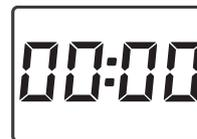
Bei dieser Displayanzeige die Uhrzeit im Format HH:MM mit dem Drehregler eingeben und Drehregler zum Bestätigen drücken. Der jeweils blinkende Wert kann eingestellt werden.
